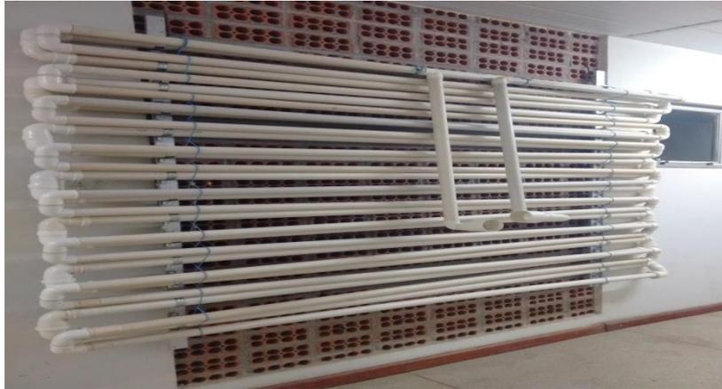
Figura 7. Experimento de velocidade do som em tubos
