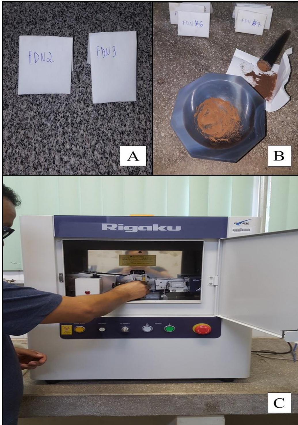
Figura 4: (a) Identificação das amostras para análise; (b) Pulverização das amostras no grau de ágata; (c) Análise no difratômetro de raio X.
