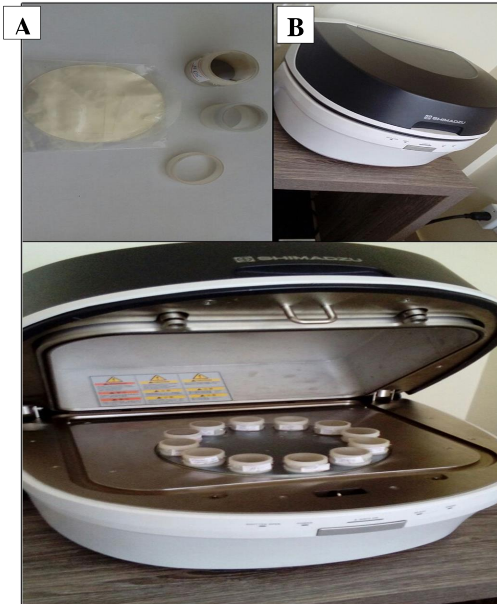
Figura 5: (a) Preparação da amostra para análise em ED X; (b) Aparelho de ED X SHIMADZU e (c) Aparelho com as 12 amostras alocadas pra análise.
