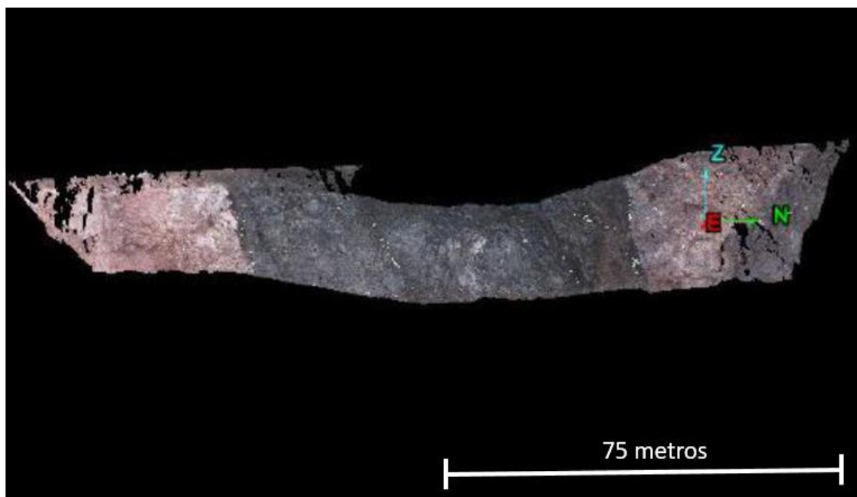
Figura 14 - Nuvem de Pontos 3D representando um imageamento feito no talude da mina
