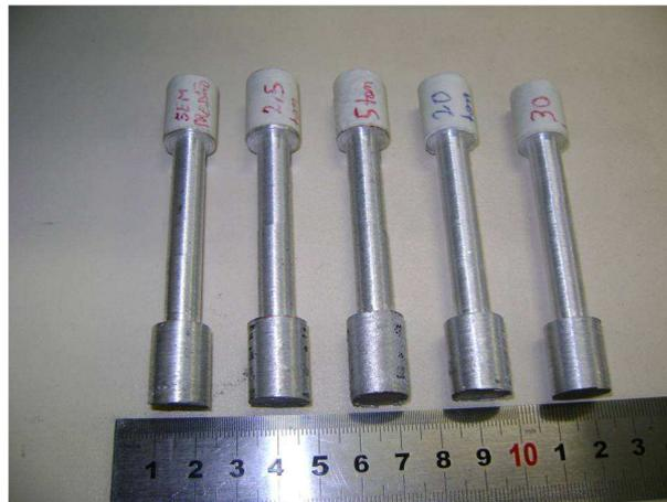
**Figura 3.13** – Corpos de prova de ensaio de tração
