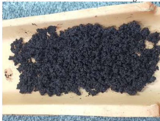
Figura 5. Amostra macerada com NaOH e água destilada.
