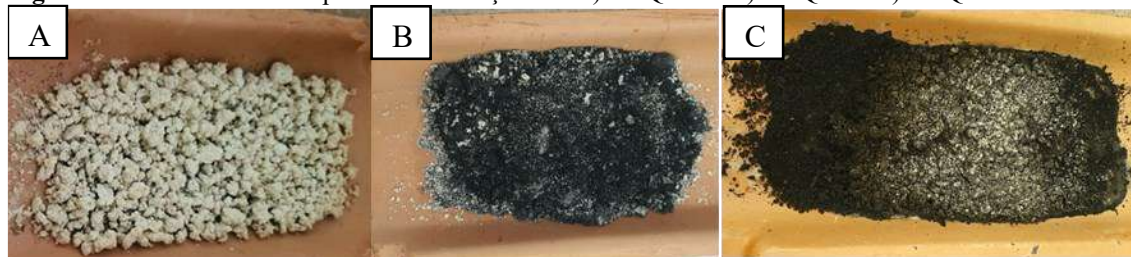
Figura 8. Materiais obtidos após a carbonização: do A) CAQI-700 B) CAQ-500 C) CAQI-500
