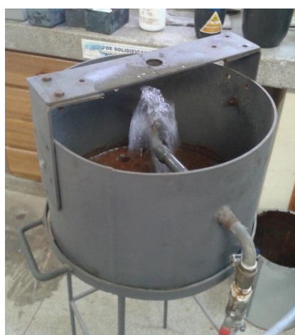
Figura 10 – a) dispositivo Jominy, b) temperatura de austenitização, c) CP's austenitizados.
