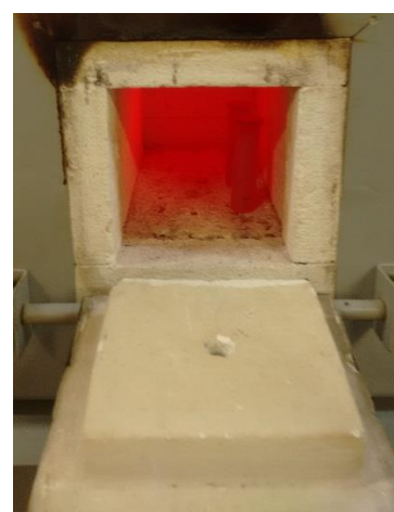
Figura 10 – a) dispositivo Jominy, b) temperatura de austenitização, c) CP's austenitizados.
