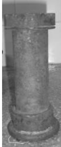
FIGURA 16. Foto da Lingoteira bi-partida.
