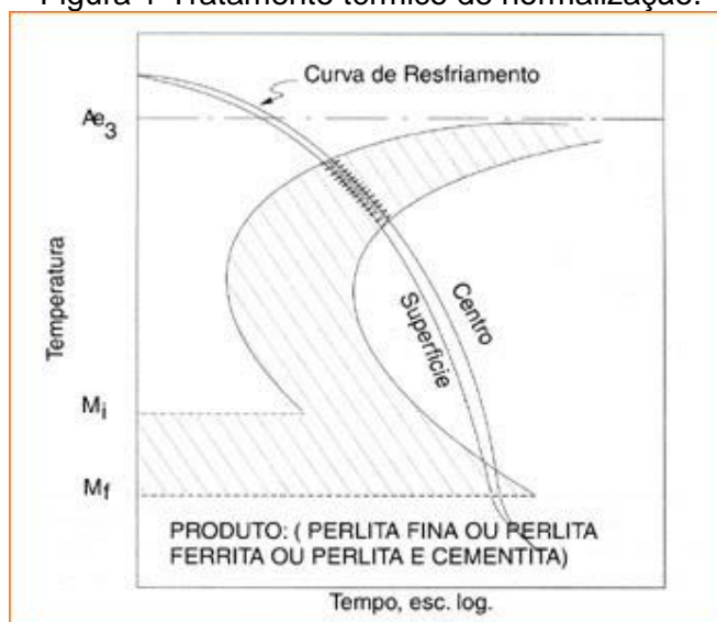
Figura 1-Tratamento térmico de normalização.
