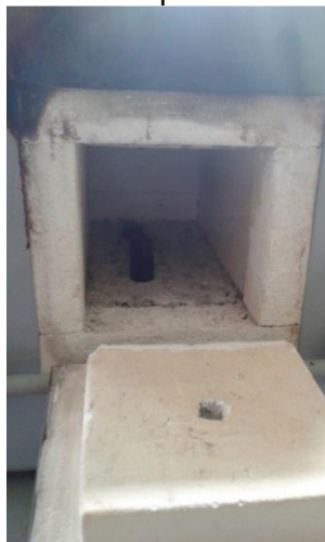
Figura 7-Forno mufla utilizado para a normalização das peças.
