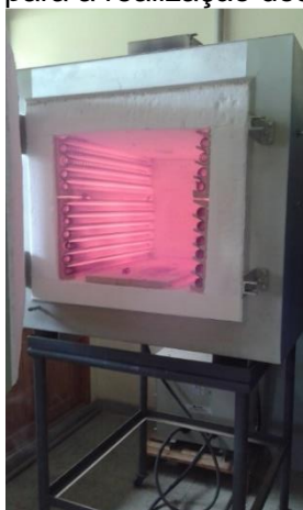
Figura 8-Forno usado para a realização dos tratamentos térmicos.
