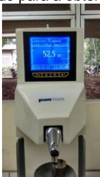
Figura 11-Durometro usado para a obtenção qualitativa da dureza.
