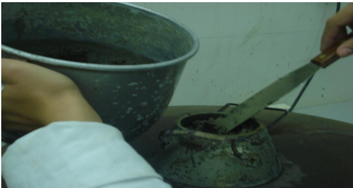
Figura 10 - Preenchimento de molde para ensaio de índice de consistência.
