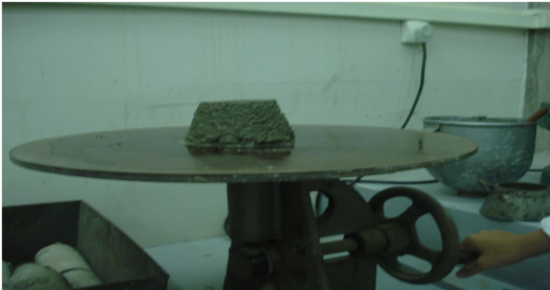
Figura 11 - Mesa de determinação do índice de consistência de argamassa.
