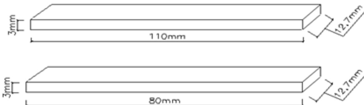
Fonte: Norma ASTM D-3039 e D-790, 1995.
