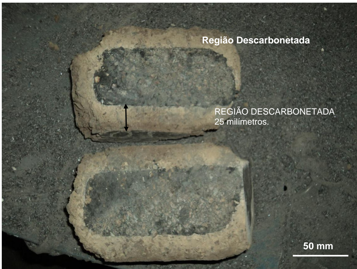
Figura 24: Região Descarbonetada do Refratário Dolomítico Pichado.
