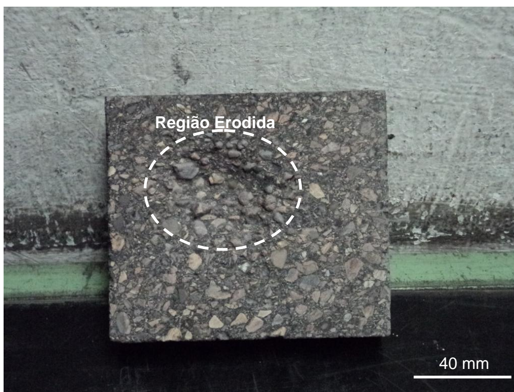
Figura 21: Placa refratária mostrando o aspecto da região erodida após ensaio.
