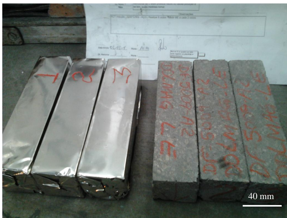
Figura 18: Corpos-de-prova revestidos por folha de níquel para o teste de erosão.
