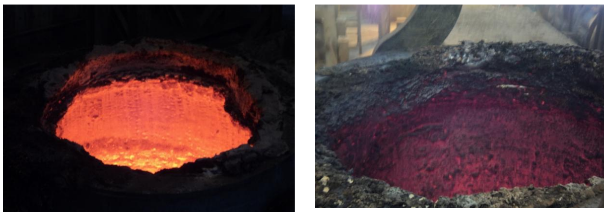
Figura 13: Aspectos visuais da diferença de temperatura do revestimento refratário.
