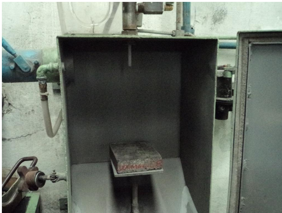
Figura 17: Placa refratária no equipamento de ensaio de erosão.
