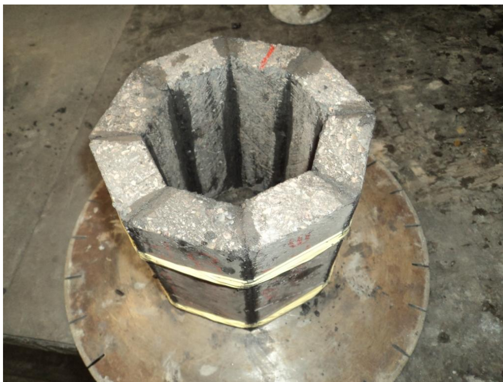
Figura 19: Montagem do cadinho para o ensaio de resistência ao ataque por escória.
