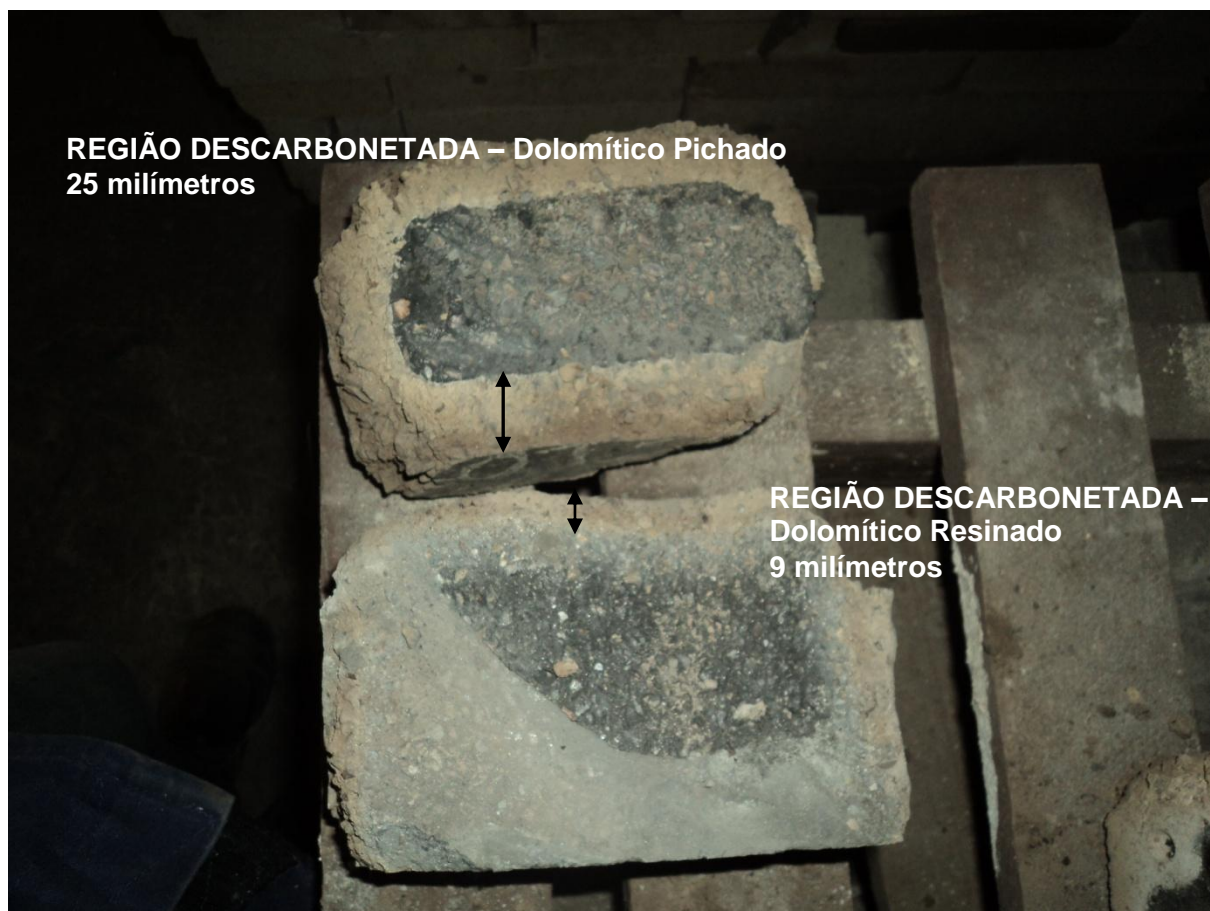
Figura 25: Aspecto comparativo da região descarbonetada dos refratários dolomíticos estudados.
