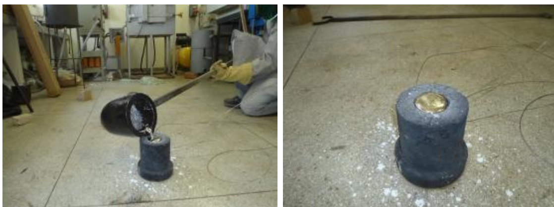
Figura 11- Vazamento e solidificação da liga
