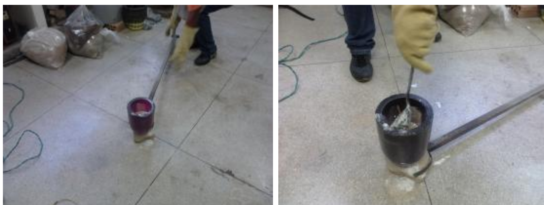
Figura 8 - Retirada do cadinho do forno adição do cobre utilizado como elemento deliga.
