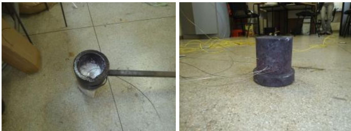
Figura 10- Verificação da T_v e disposição dos termopares
