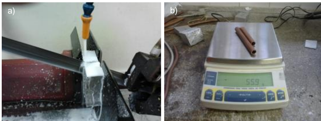
Figura 5- Corte (a) e pesagem (b) dos metais utilizados para a confecção das ligas.
