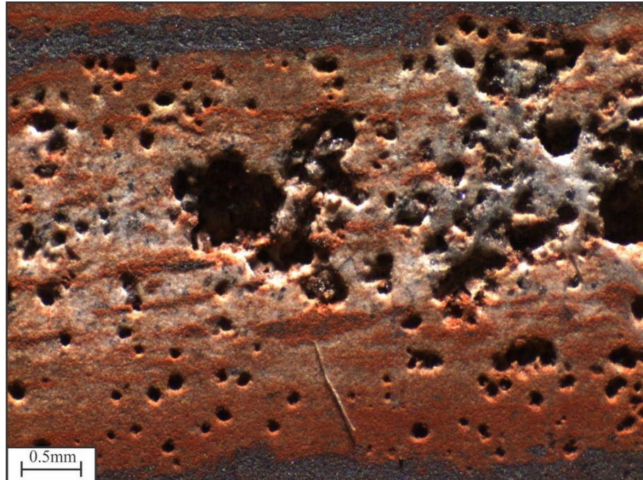
FIGURA 28 - Cavidades arredondadas observadas na lupa binocular. Notar aumento dos tamanhos em direção ao centro da camada, onde há mais chert . Amostra N4E1281(119.41-119.55).
