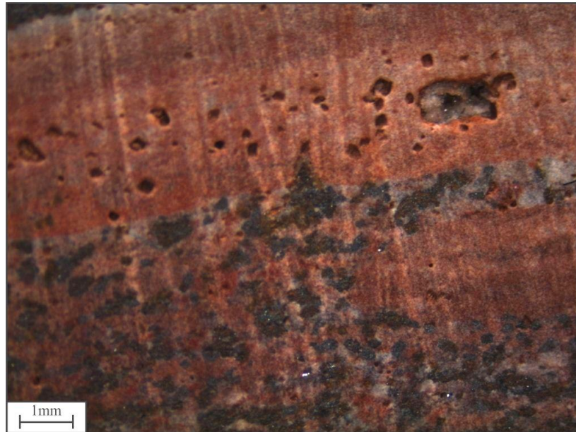
FIGURA 22 – Cavidades vistas na lupa binocular, dispostas ao longo da banda de sílica, paralelas ao bandamento da rocha. Notar paredes feitas de jaspe e intercrescimento de quartzo granular no interior da estrutura. Amostra N4E(50.39-50.53).
