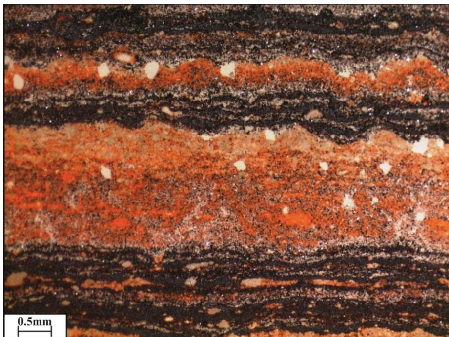
FIGURA 16 - Imagem na lupa binocular, evidenciando o contato regular entre topo da banda de óxidos e base da banda de jaspe, em contraste com o contato superior da banda de jaspe, mais ondulado, porém brusco. Amostra N4E1304(102.40-102.50).
