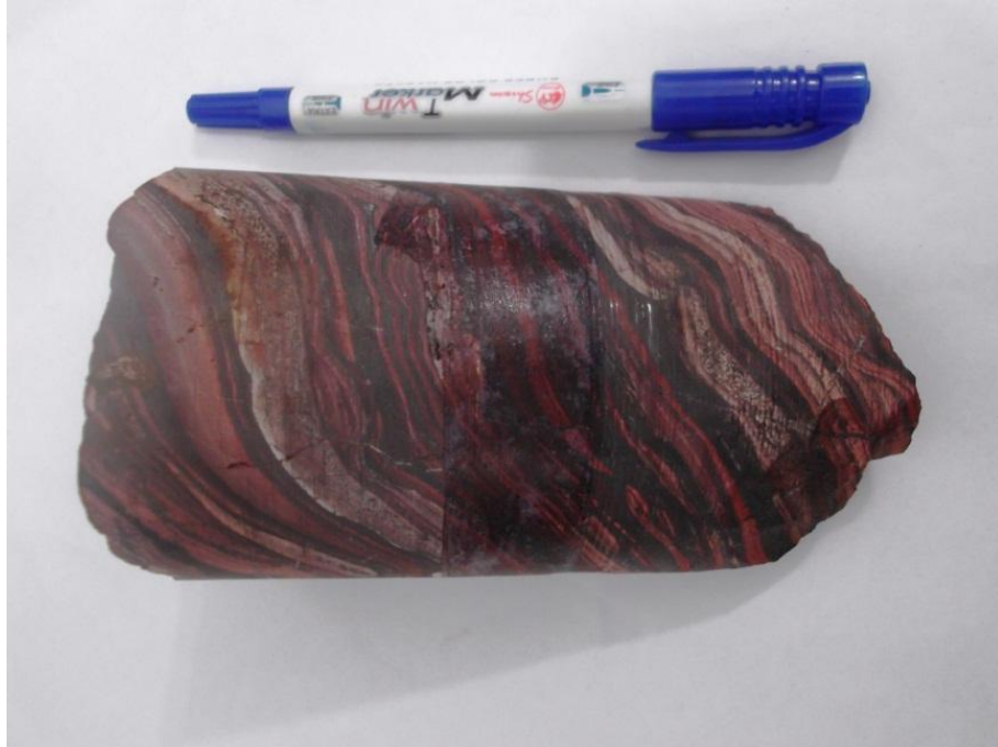
FIGURA 15 - Foto de jaspilito pouco alterado mostrando escassos sinais de alteração nas bandas predominantemente silicosas, e preservação das características da rocha não alterada.
