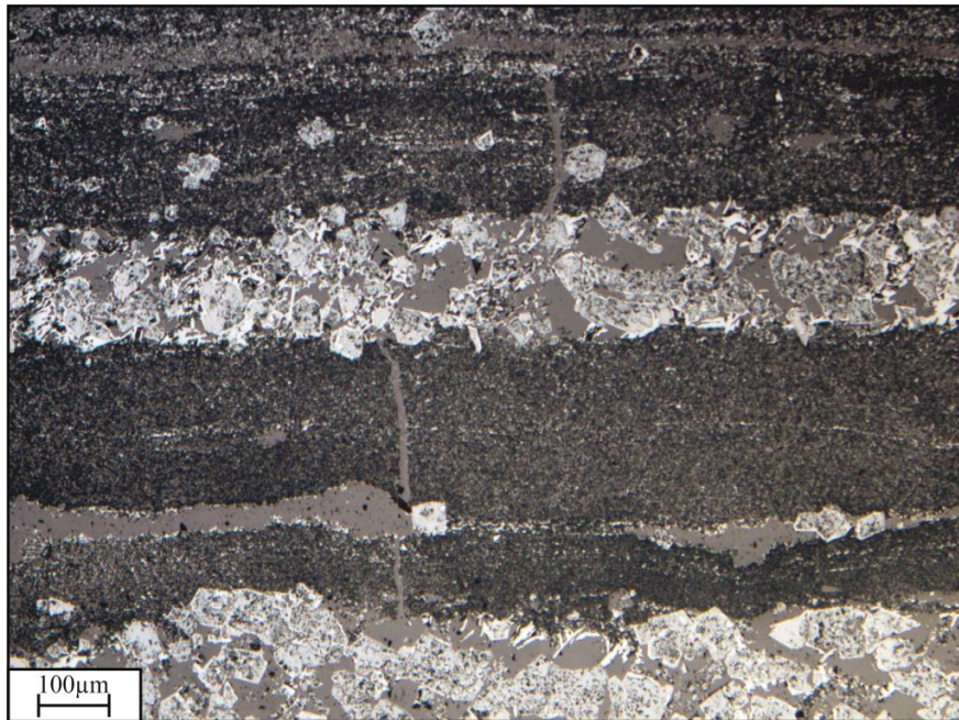
FIGURA 20 – Banda de opacos mostrando laminação plano paralela evidenciada pelas lâminas de hematita 1 (micro-cristais formando lâmina mais escura), agregados de cristais de magnetita parcialmente alterados para maghemita e níveis de jaspe. Amostra N4E487(50.39-50.53). Luz refletida.
