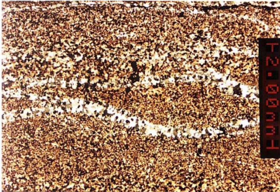
FIGURA 13 – Jaspe a nicóis cruzados, exibindo microcristais de quartzo e característica cor avermelhada, resultado da impregnação por hematita. Amostra AJ-02. (Fonte: Macambira 2003).
