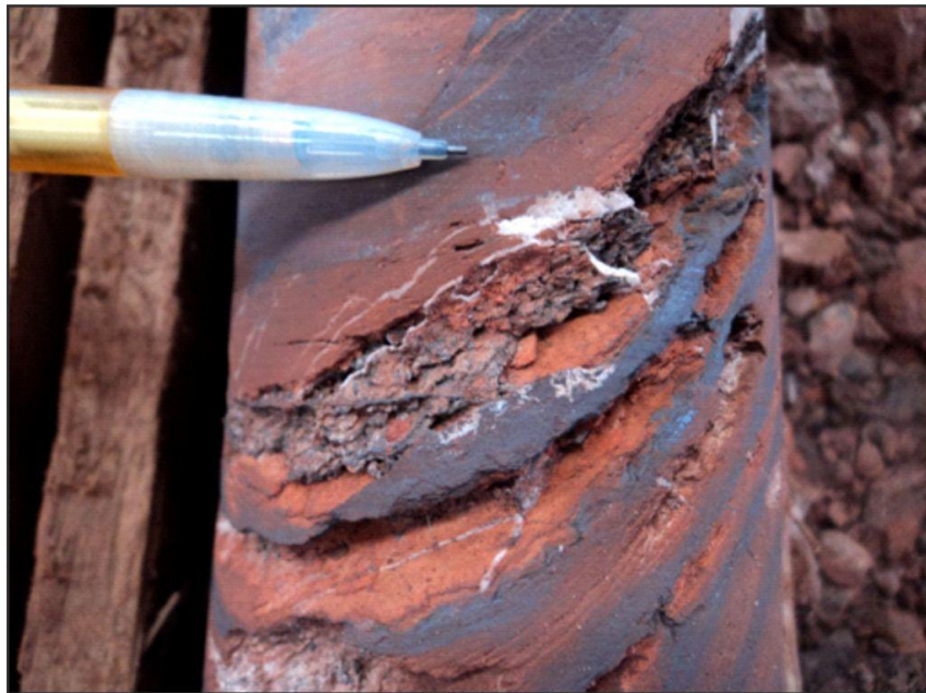
FIGURA 24 – Amostra de mão que representa o Jaspilito alterado. Observar que intensa lixiviação da sílica deixa cavidades ainda maiores, lenticulares, paralelas ao bandamento e com paredes de jaspe. Amostra N4E 487(120.43-120.55).
