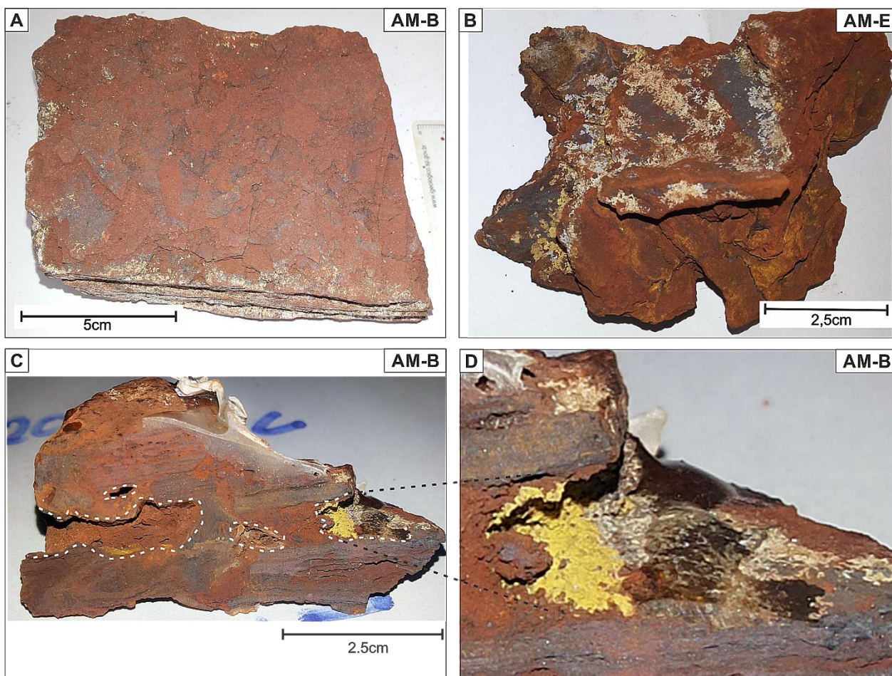
Figura 14: Feições Macroscópicas de Crostas Branca e Amarela recobrendo Formações Ferríferas Bandadas. A- BIF recoberta por Crosta Branca e em pequenas porções Crosta Amarela. B- BIF recoberta por Crosta Branca e Amarela na mesma proporção C- No interior de micro cavidades observa-se a presença de Crosta Amarela em maior proporção e também Crosta Branca D- Detalhe de micro cavidade com presença das Crostas.
