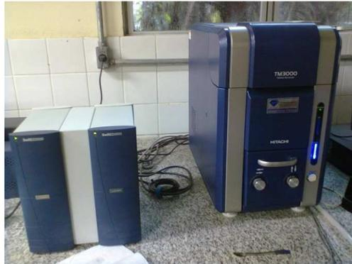
**Figura 4.3** – Microscópio eletrônico de bancada Hitachi modelo TM-3000 com EDS acoplado.
