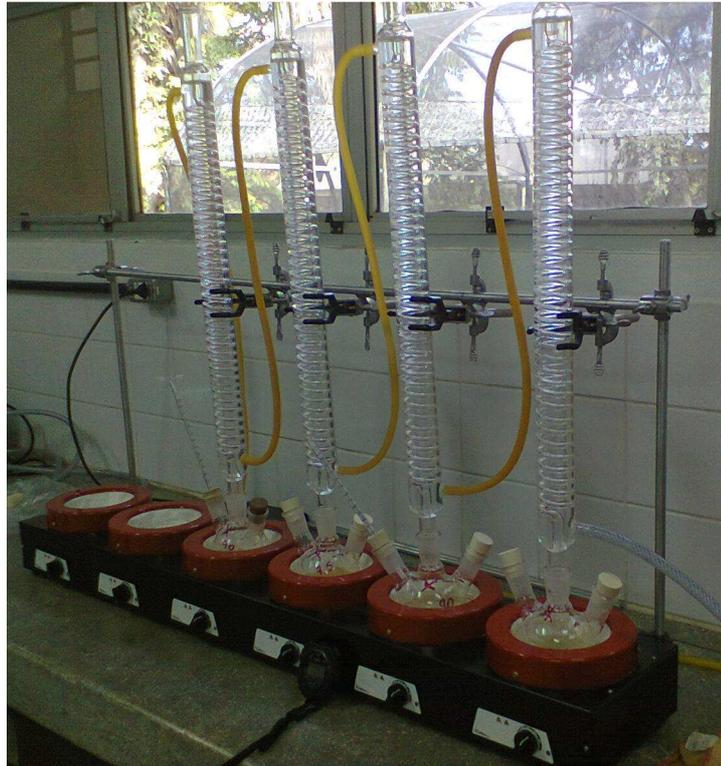
**Figura 4.1** – Sistema de manta aquecedora e refluxo utilizado na saponificação.
