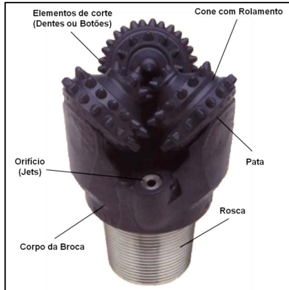
FIGURA 03 – Os principais elementos de uma broca tricônica. Fonte: MORAIS (2001)
