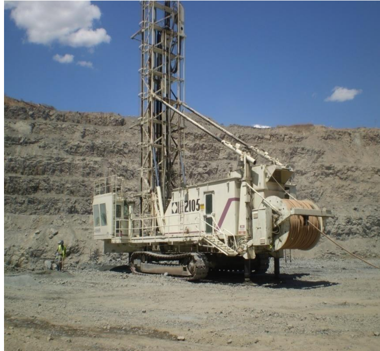
Figura 9. Perfuratriz Elétrica 49 HR
