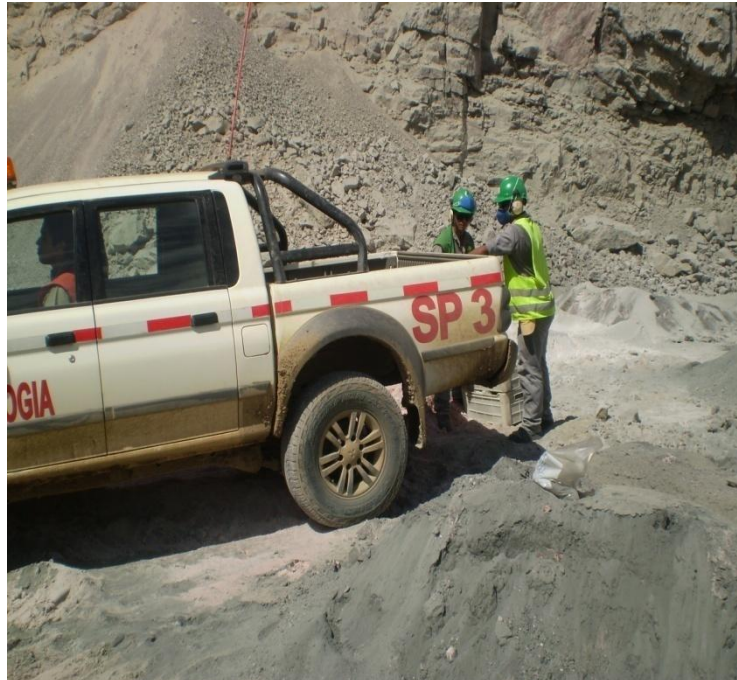
Figura 12. Coleta do material dos furos para análise de teor.
