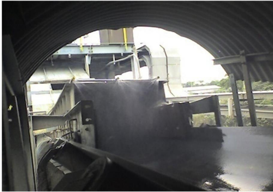
Foto 11 – Aspersores de água para supressão de poeira numa correia transportadora. Fonte: Mina do Sossego
