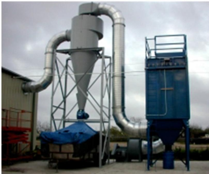
Foto 06 – Ciclone ligado a um Filtro de manga. Fonte: Modulo IV – Equipamentos de Controle de Poluição do Ar. UFES - UNIVERSIDADE FEDERAL DO ESPÍRITO SANTO
