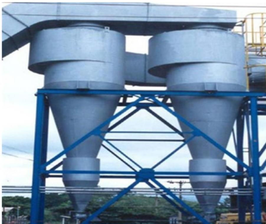
Foto 04 – Ciclones. Fonte: Módulo IV – Equipamentos de Controle de Poluição do Ar. UFES - UNIVERSIDADE FEDERAL DO ESPÍRITO SANTO
