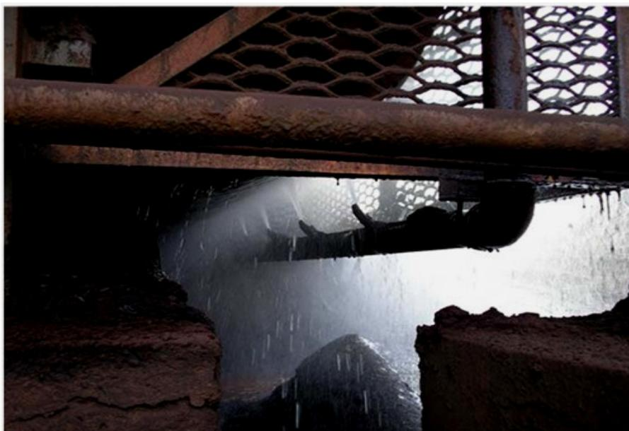
Foto 09 – Aspersor de água para supressão de poeira num chute de descarga. Fonte: PRUNER Automações.
