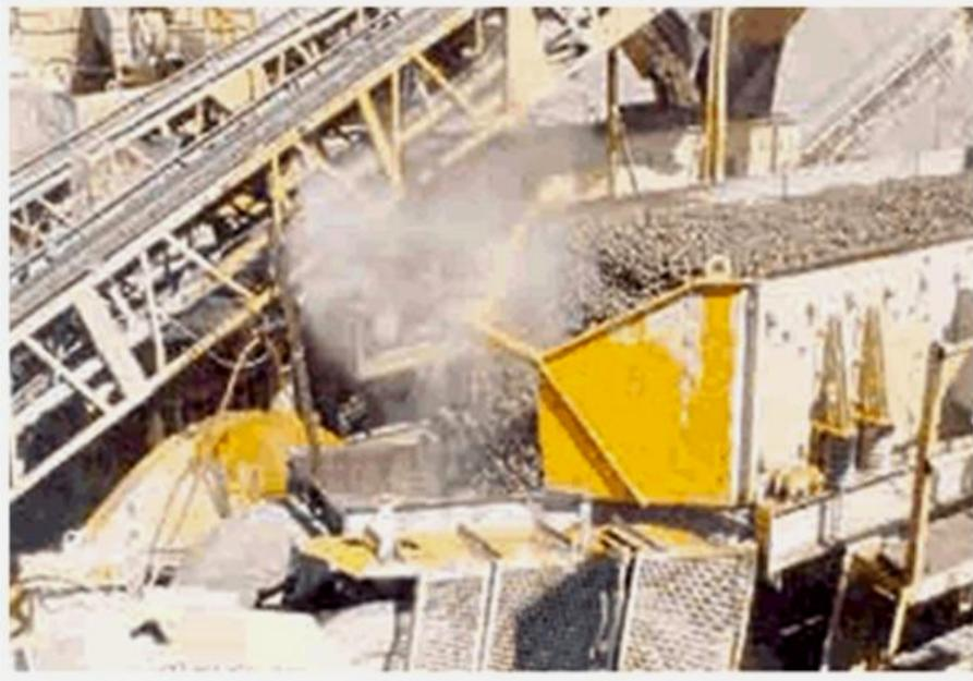
Foto 15 – Sistema de abatimento de pó numa correia de alimentação do britador.
