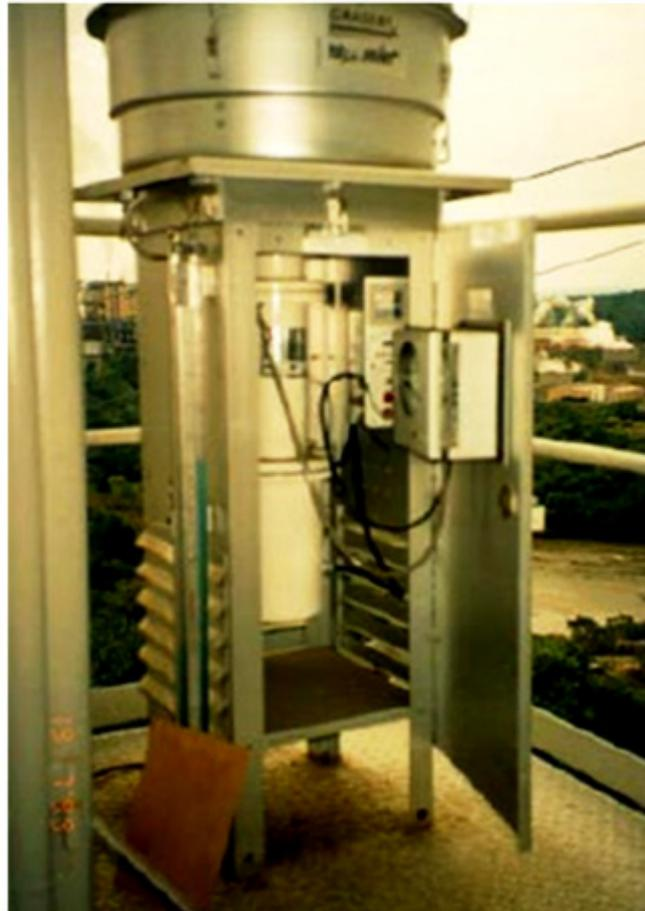
Foto 01 – Hi-Vol MP<sub>10</sub> utilizado para coleta de material particulado de tamanho menor que 10 $\mu$ m. Fonte: Cap. 04 Monitoramento de Poluentes Atmosféricos.
