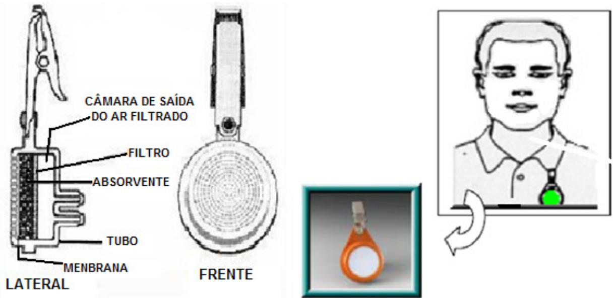
Figura 01 – Amostrador Passivo. Fonte: Modificada do Cap. 04– Monitoramento de Poluentes Atmosféricos.
