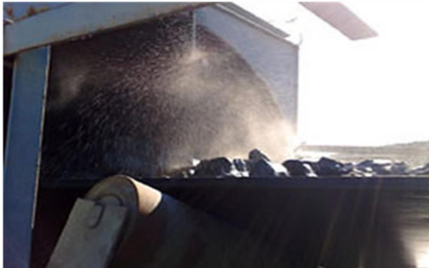
Foto 12 – Bicos aspersores atuando numa correia transportadora. Fonte: ASPERMINAS
