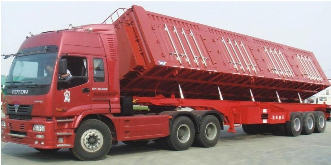
Foto 7: Caminhão de Descarga Lateral. Fonte: Foton.
