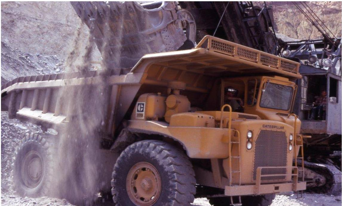
Foto 5: Caminhão de Descarga Traseira. Fonte: Caterpillar
