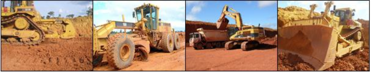
Figura 26: Método tradicional de carregamento de bauxita utilizando EH CAT 365CL. Fonte: Mendes, 2013.
