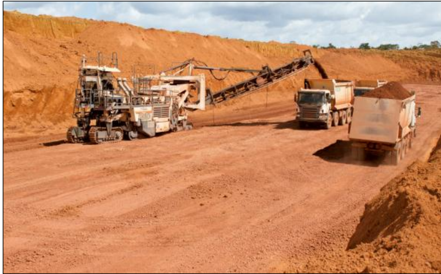
Figura 27: Minerador de superfície fazendo o carregamento da bauxita.
