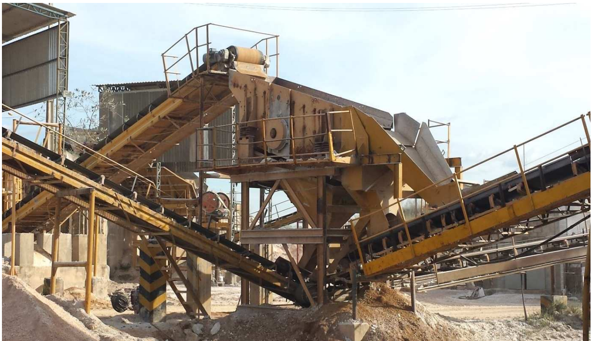
Figura 11 - Peneira Vibratória Inclínada Piacentini modelo PVA 1540 da empresa Caltins. Fonte: Arquivo pessoal, 2014.
