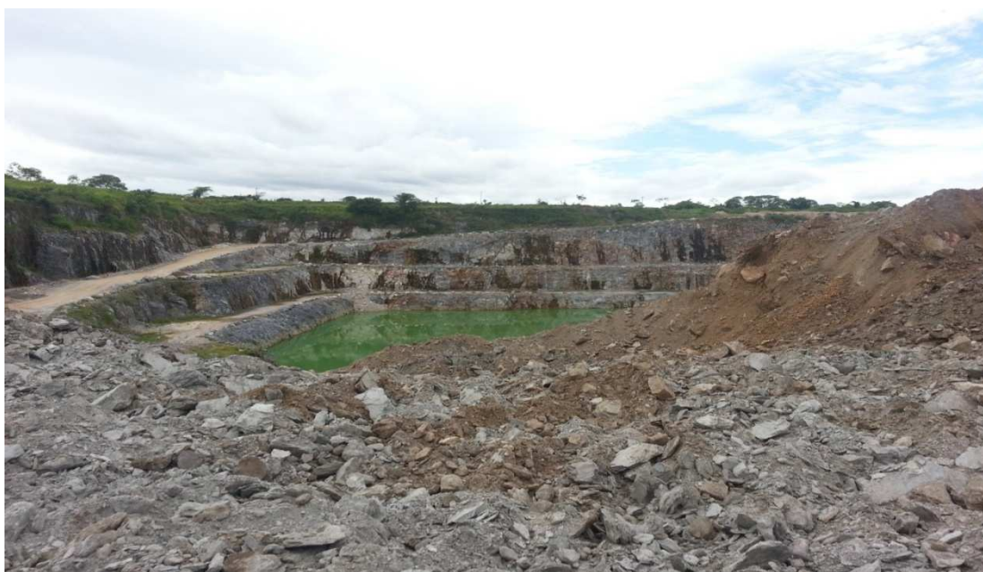
Figura 9- Lavra por bancada realizada na mina Corgão. Fonte: arquivo pessoal, 2014.
