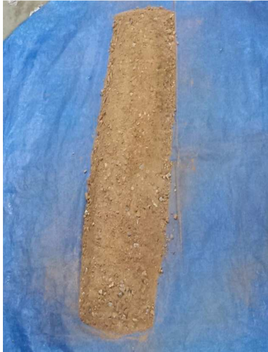
Figura 14- Pilha alongada de amostra para realização do quarteamento. Fonte: Arquivo pessoal, 2014.
