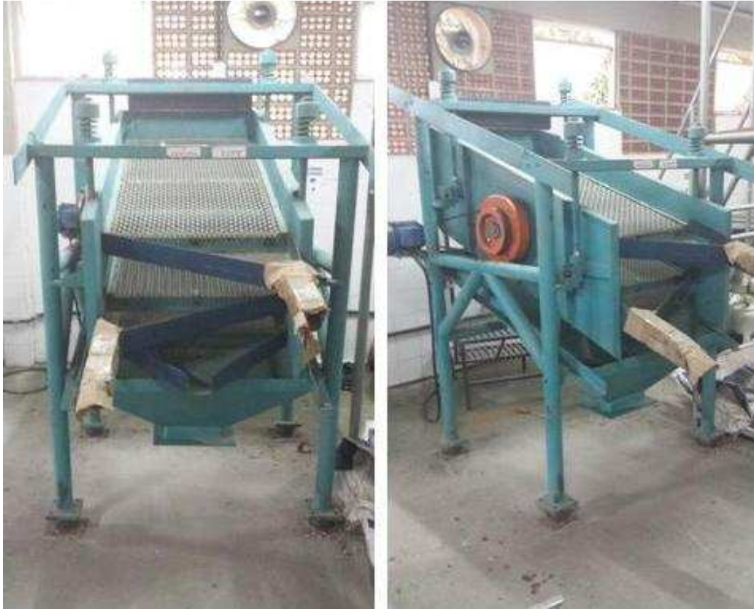
Figura 15- Peneira vibratória inclinada utilizada no experimento. Fonte: Arquivo pessoal, 2014.
