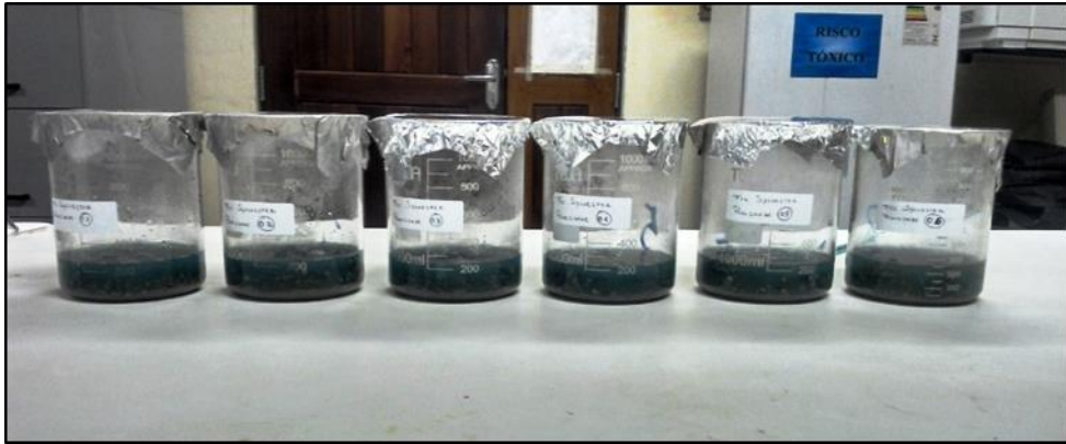
Figura 5.7 - Ensaio de lixiviação realizados em béqueres.
