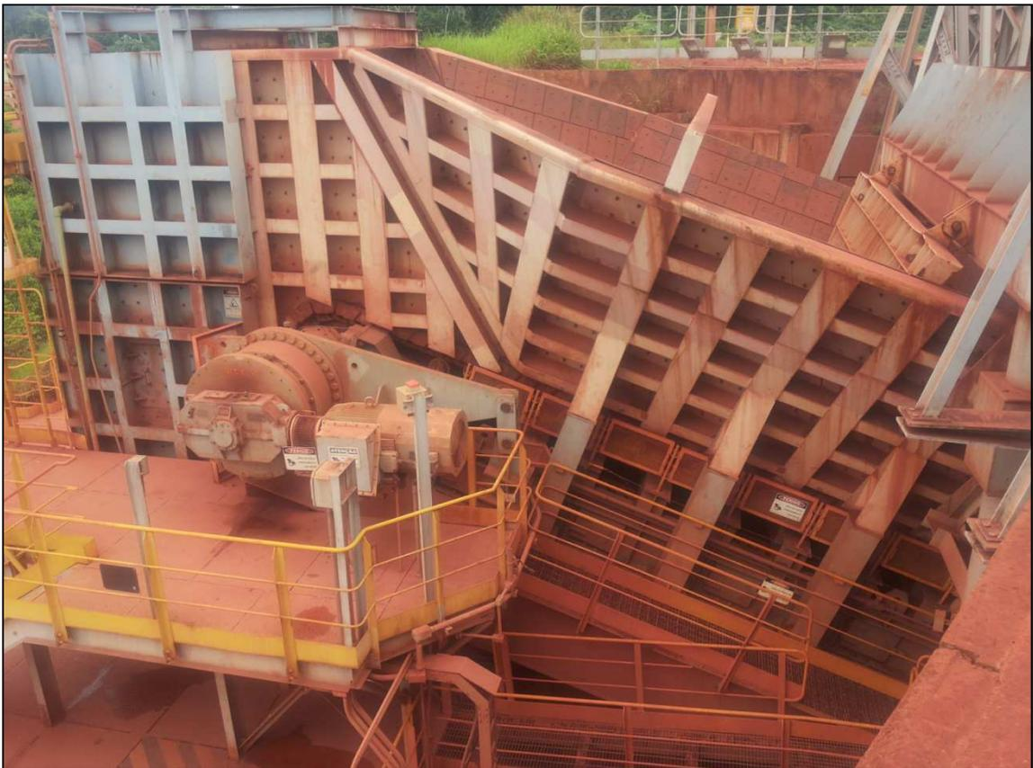
Figura 17 – Vista externa do britador primário.
