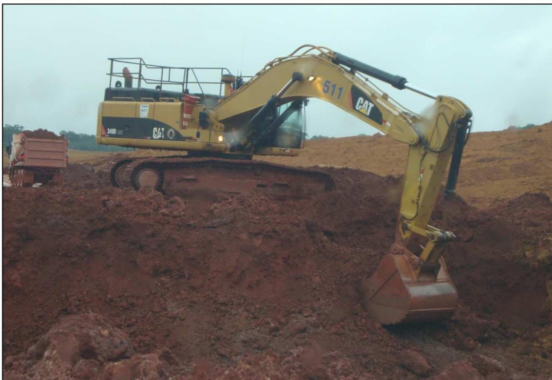
Figura 13 – Escavadeira hidráulica CAT 349D lavrando bauxita.
