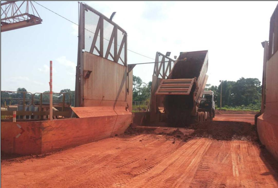
Figura 14 – Caminhão basculante descarregando minério na moega do britador primário.
