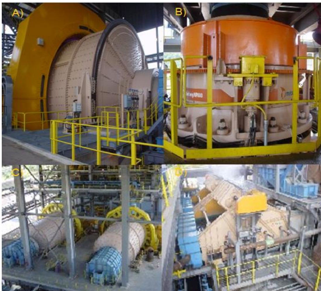
Figura 8. Processos presentes na usina: A) Moinho SAG, B) Rebitador, C) Moinhos de bolas e D) Peneiras.
