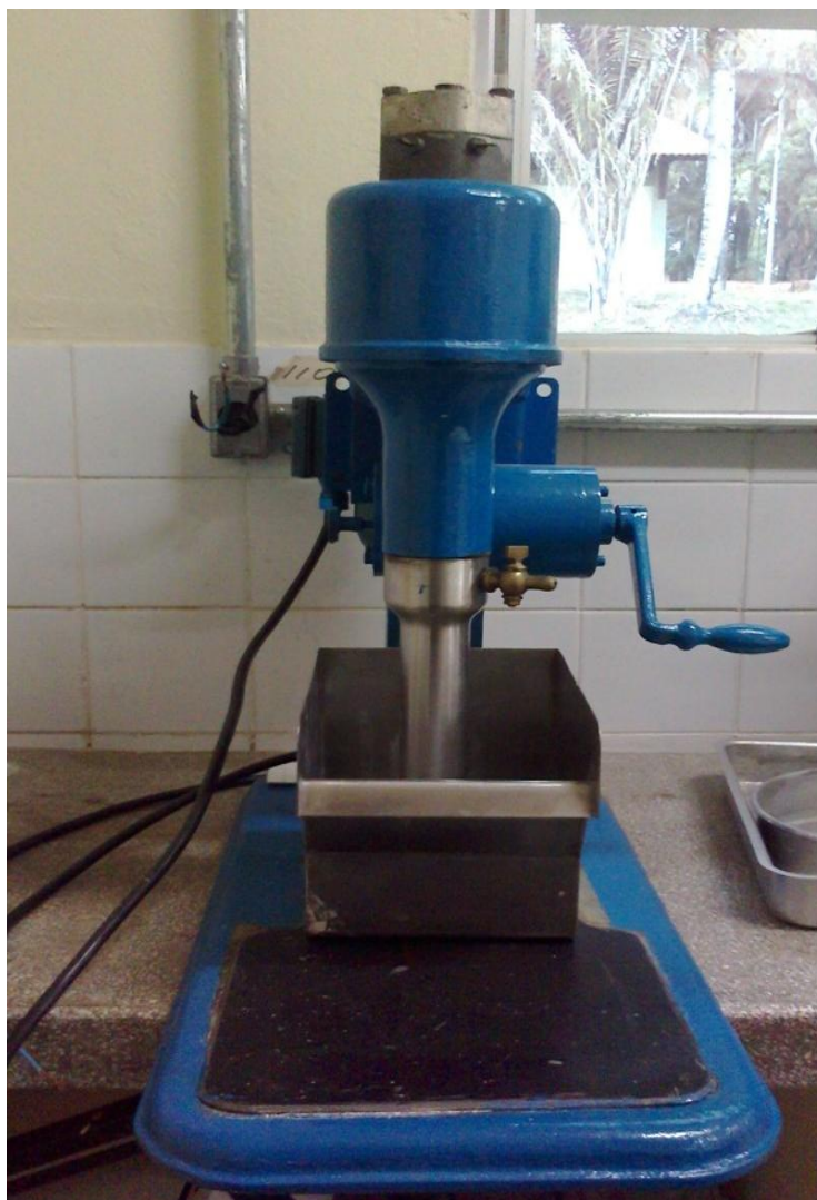
Figura 17. Imagem da célula de flotação utilizada nos ensaios.
