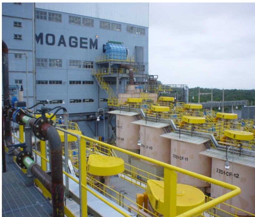
Figura 10. Células de flotação da etapa rougher na usina do Sossego.
