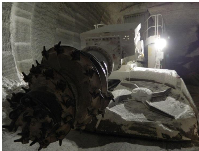
Figura 24 – Fresa mecânica (minerador contínuo).
