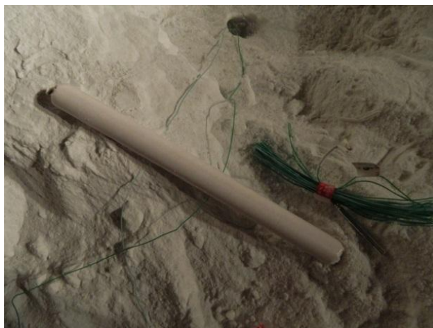
Figura 28 – Explosivo PREMEX 300 e detonador RIODET.
