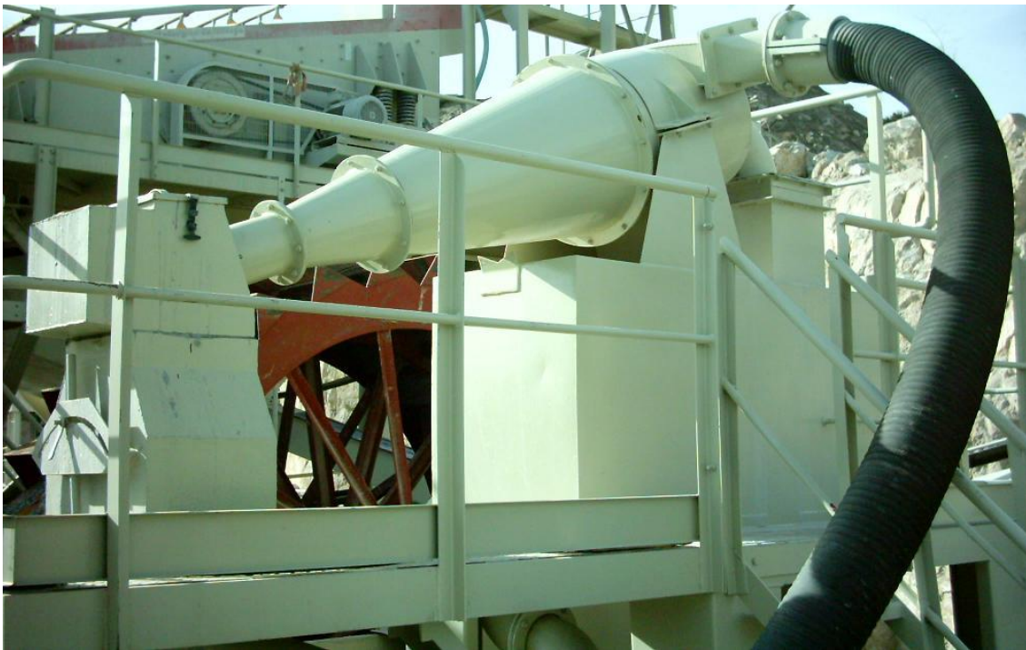
Figura 16 – hidrociclone utilizado na recuperação de areias Fonte:metaltamega.lvengine.com/lmgs/content/page_50/HidroCICLONE_i1.JPG
