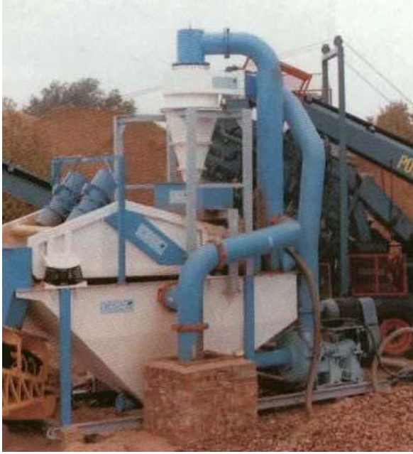
Figura 17 – hidrociclone utilizado na lavra de areias Fonte: BOUSO (1990)
