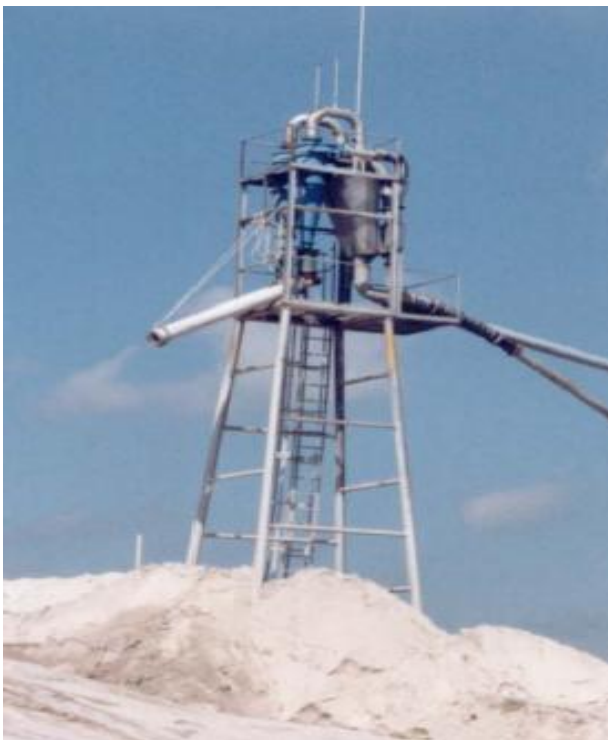
Figura 18 – Hidrociclonação na recuperação de areias finas Fonte: BOUSO (1990)
