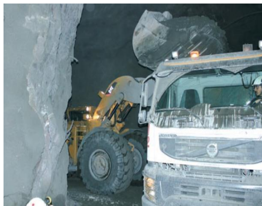
Figura 17 - Caminhão Volvo sendo carregado através da LHD
