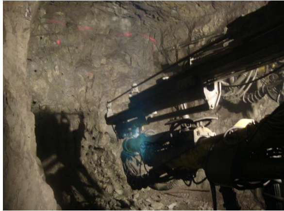
Figura 20 - Perfuratriz em operação na frente de rocha.
