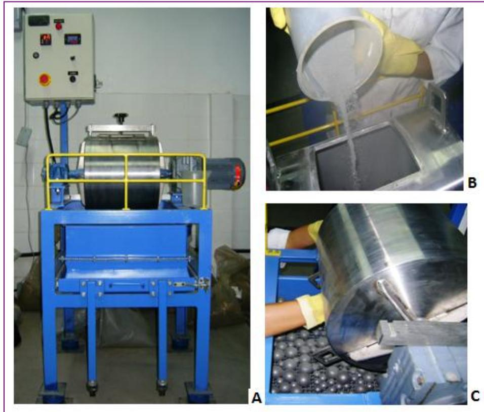
**FIGURA 08-** Em (A) moinho de bolas tipo Bond, em (B), alimentação inicial no moinho e, em (C), descarga após a moagem do minério.
