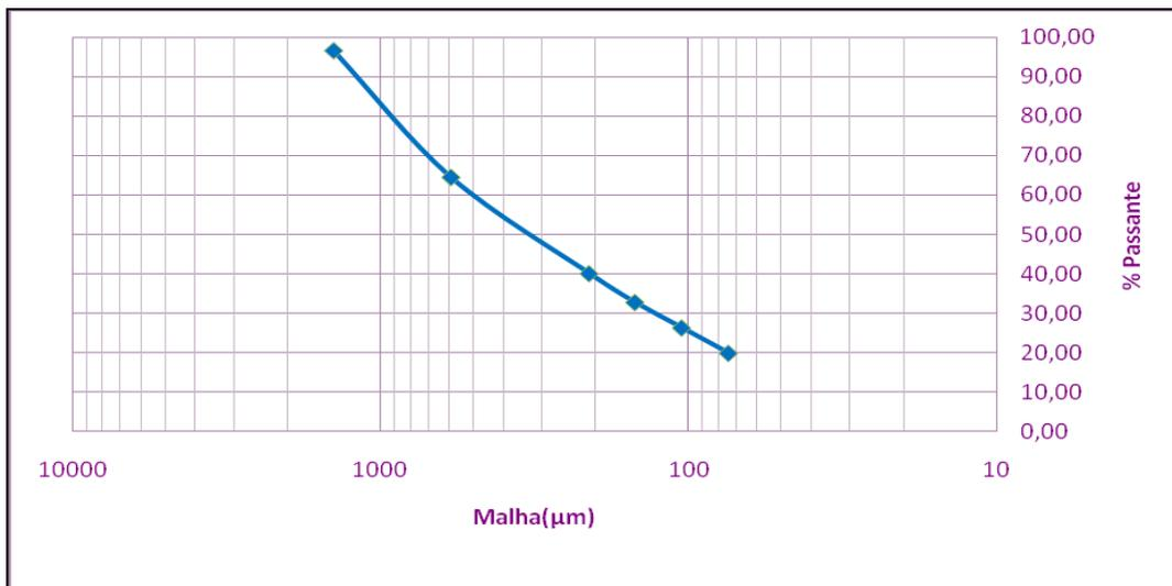
**FIGURA 12** - Curva granulométrica da alimentação do segundo ensaio.
