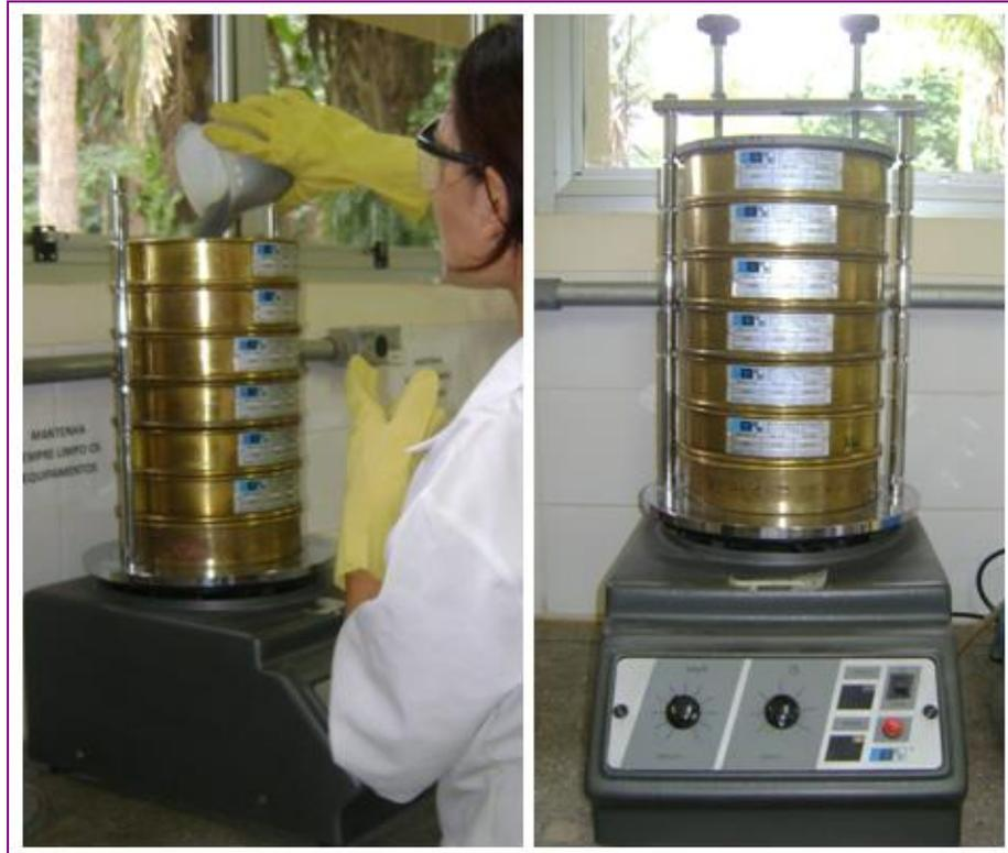
**FIGURA 9-** Peneiramento para análise granulométrica do produto de moagem para se calcular o passante na malha-teste e o passante líquido.
