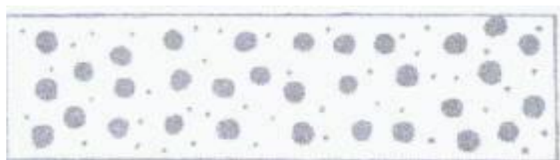
Figura 3.5 – Esquema interno de uma cavidade laser contendo uma mistura de Gases Hélio-Neônio [13].
