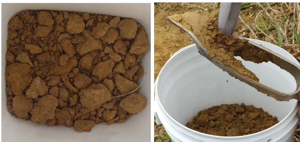
Foi também observado, uma dificuldade maior da penetração do trado no solo, durante o segundo ciclo (Figura 10), o que pode sugerir um início de compactação do solo em profundidade, alteração na sua densidade e porosidade (macroporos e microporos).
