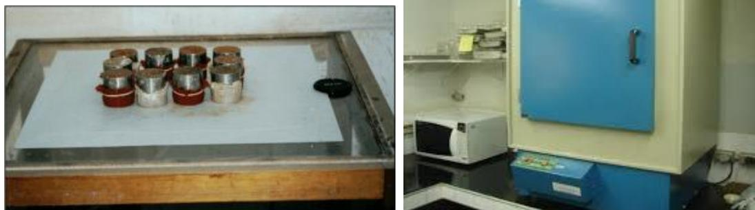
Após esse período, as amostras foram novamente submetidas a pesagem (P2) e depois foram levadas à estufa a 105°C por 24 h e foram novamente pesadas (P3). Com os pesos, procedeu-se com os cálculos, obtendo-se o volume de macro e microporos contidos nas amostras. As fórmulas utilizadas para o cálculo foram:  $\text{MACROPOROSIDADE} = (P1 - P2) \times 100/V$  e  $\text{MICROPOROSIDADE} = (P2 - P3) \times 100/V$ ;
