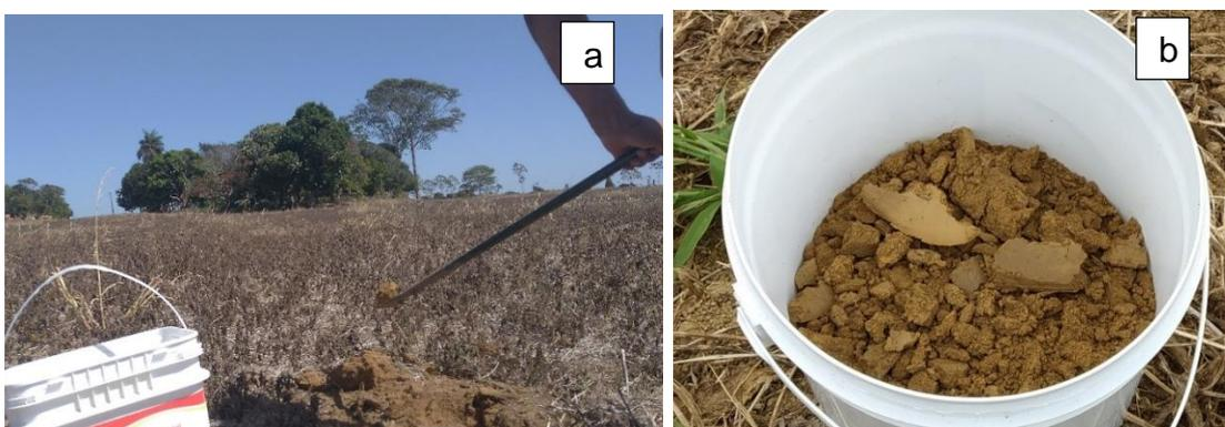
Para análise física foram separados 400g da amostra composta de solo tanto no primeiro quanto no segundo ano e encaminhadas para laboratório (Figura 6) a fim da realização da análise granulométrica que consiste na determinação da porcentagem de areia, silte,
