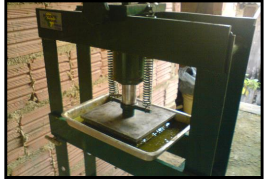
(a) (b) Figura 3.3. Molde metálico utilizado para confecção dos compósitos com diferentes teores de fibras de Luffa cilíndrica com auxílio da prensa hidráulica.
