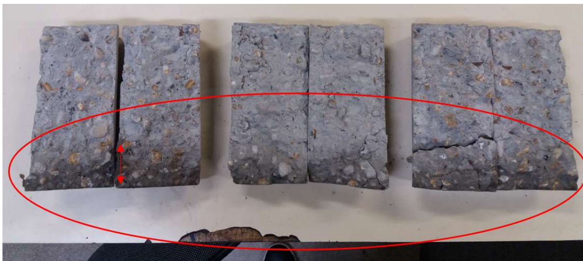
Figura 36 - Configuração de absorção por capilaridade das amostras do prédio do ICE.
