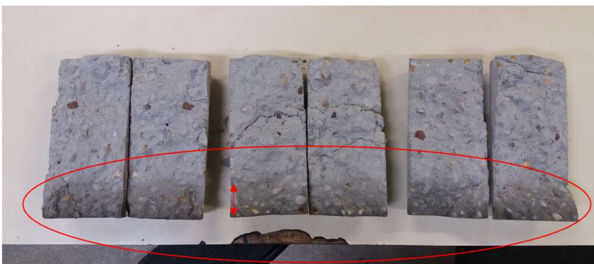
Figura 37 - Configuração de absorção por capilaridade das amostras do prédio da FAGEO.
