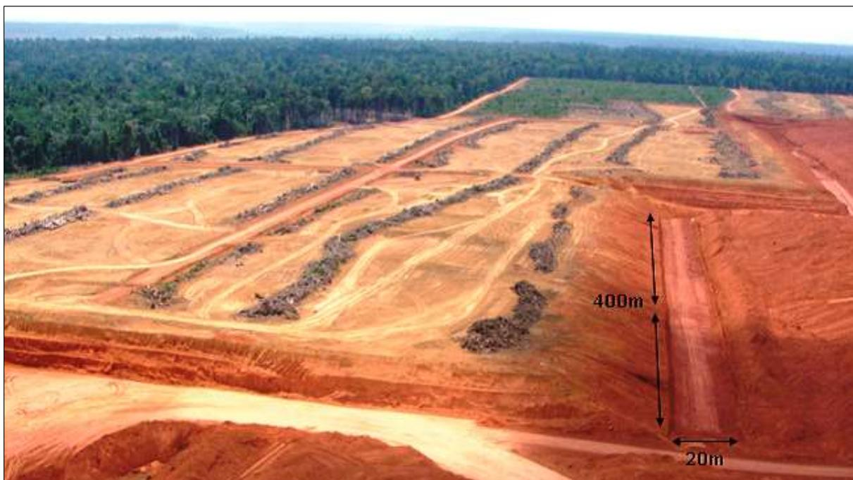
**Figura 1** – Demonstração da geometria das faixas na lavra em tiras na mina de bauxita Paragominas
