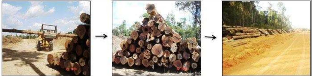
**Figura 11** - sequenciamento de operações para as toras de madeira. Elas são empilhadas, já dividindo-as em classe e, por fim, distribuídas em pontos estratégicos.
