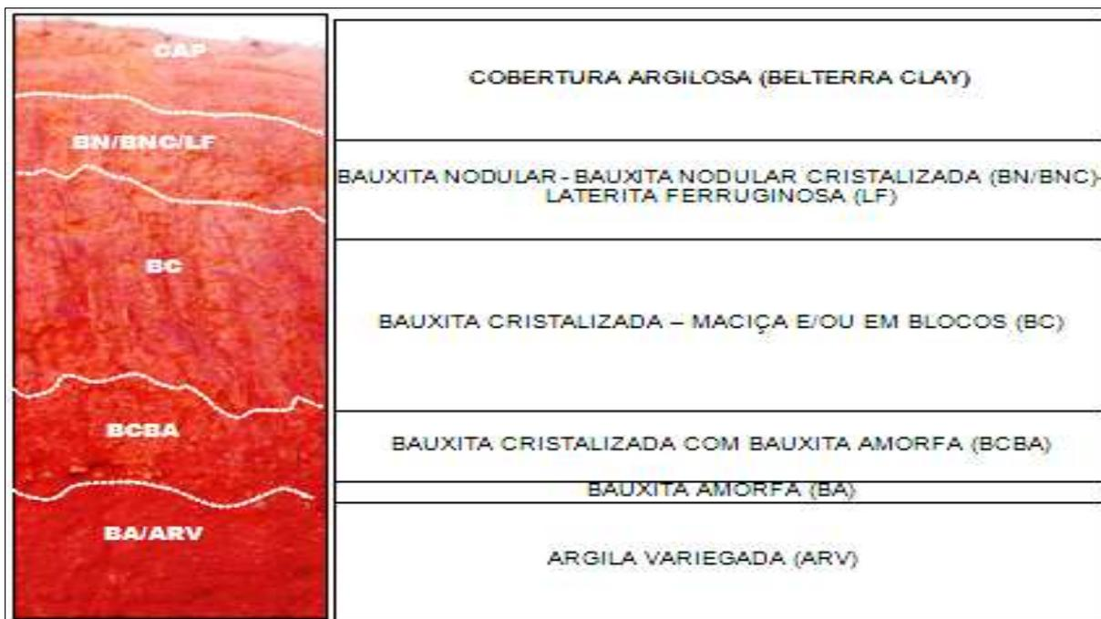
**Figura 4** – Perfil laterítico típico.
