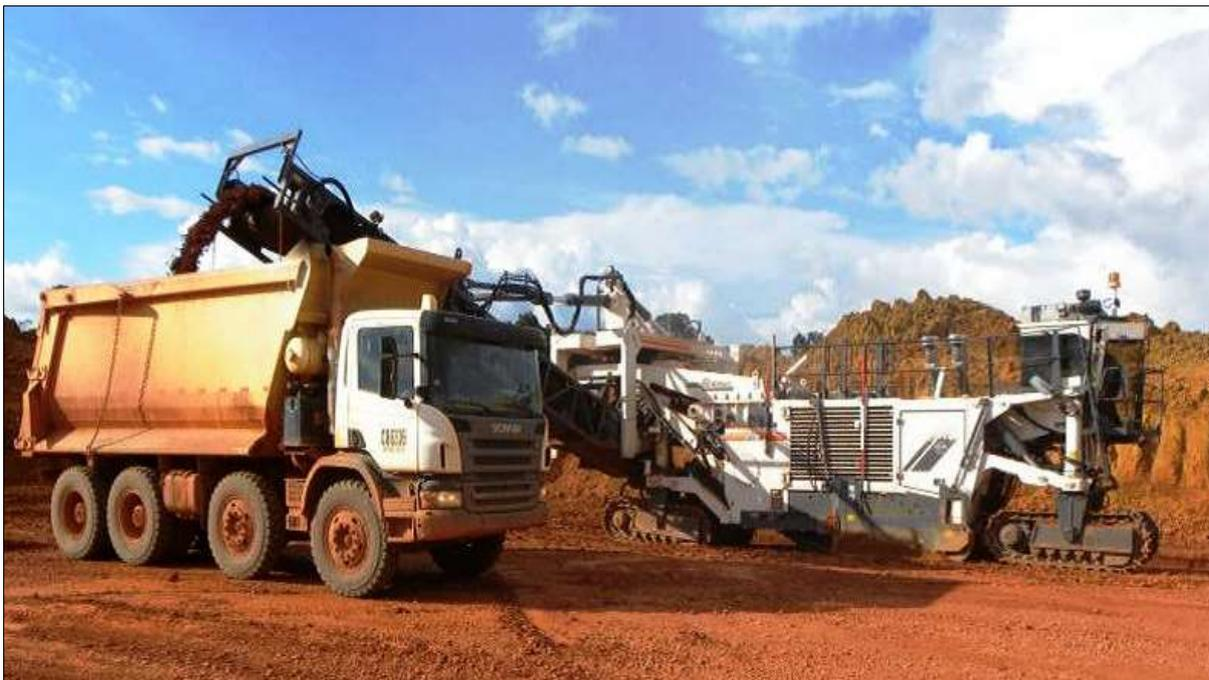
**Figura 8** - Sistema de lavra com o minerador de superfície.
