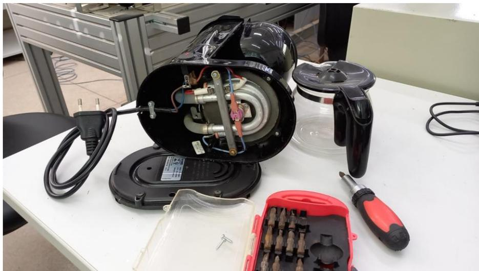
Figura 11 Verificação dos equipamentos resistivos
