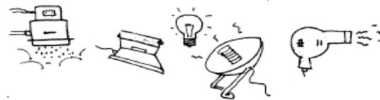
Todos eles tem em comum o fato de transformarem a energia elétrica fornecida por um fonte em energia térmica. Esses aparelhos são os que tem a construção mais simples: possuem um pedaço de fio em forma de espiral cujo nome é **resistor**.
