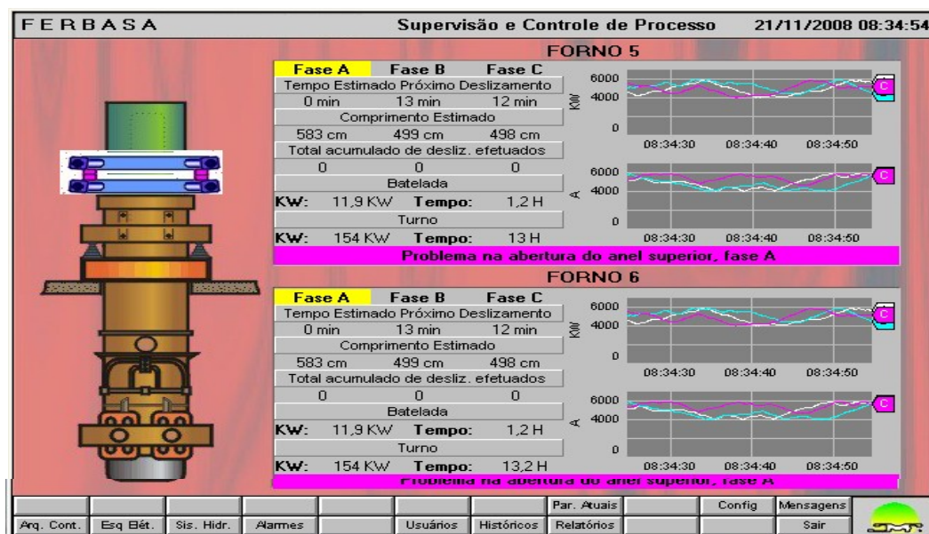
Figura 3.8: Sistemas Supervisório FERBASA
