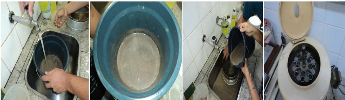
**Figura 12:** preparação das amostras de solo da área de extração de argila da Cerâmica Barro Bom para peneiramento úmido e centrifugação.
