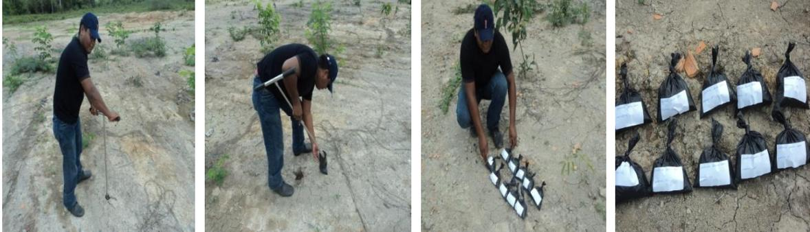
**Figura 11:** Coletas de amostras de solo, da área de extração de argila da Cerâmica Barro Bom, armazenamento e identificação das mesmas.
