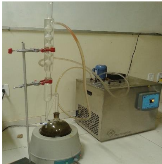
Figura 07: Aparato para extração do óleo essencial
