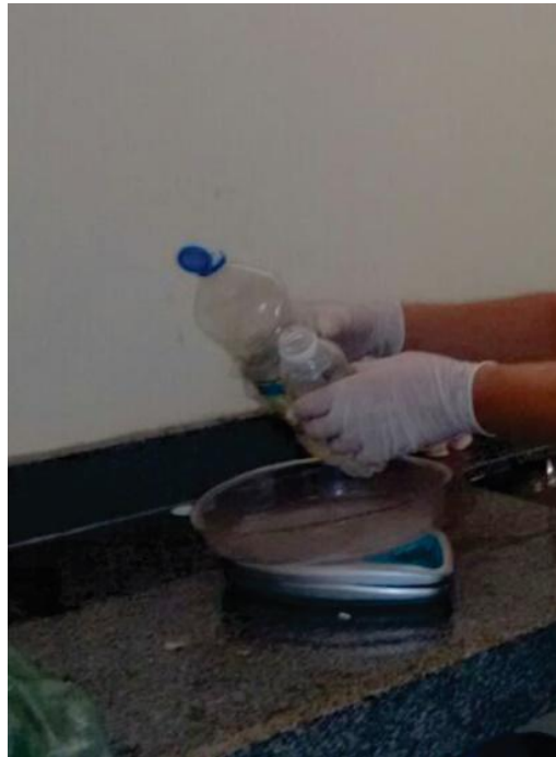
Figura 9: Pesagem dos componentes separados das amostras de resíduo.
