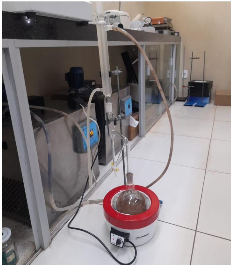
Figura 2. Processo de hidrodestilação utilizando um aparelho do tipo clevenger.
