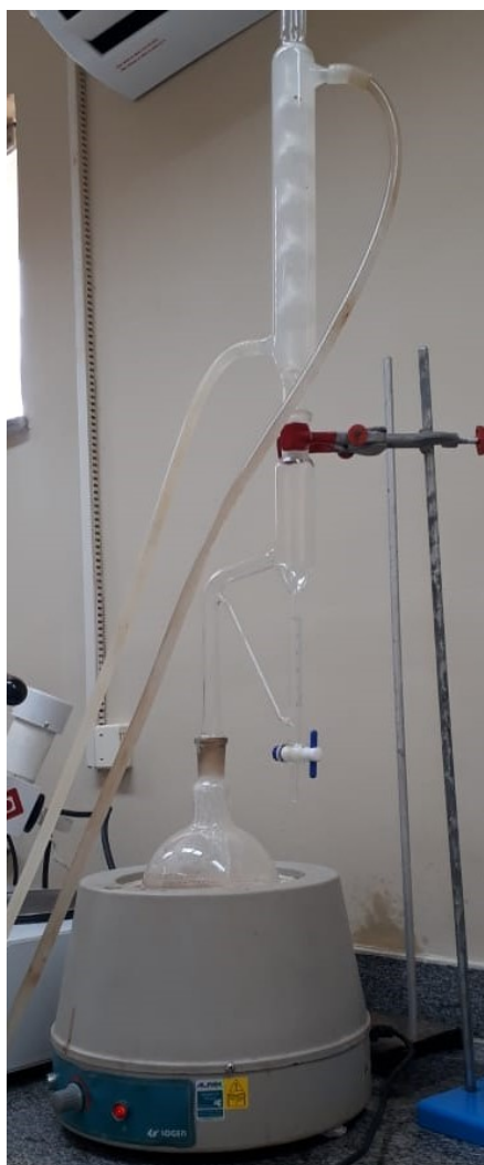
Figura 5 - Extração do óleo essencial de copaíba por hidrodestilação.
