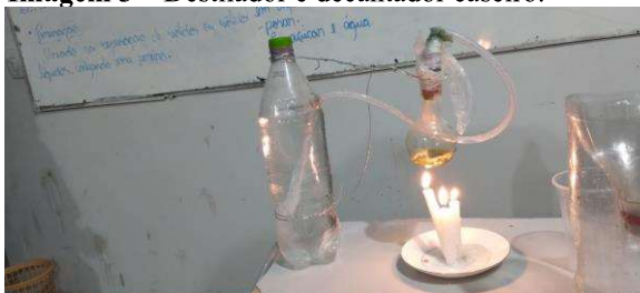
Imagem 3 – Destilador e decantador caseiro.
