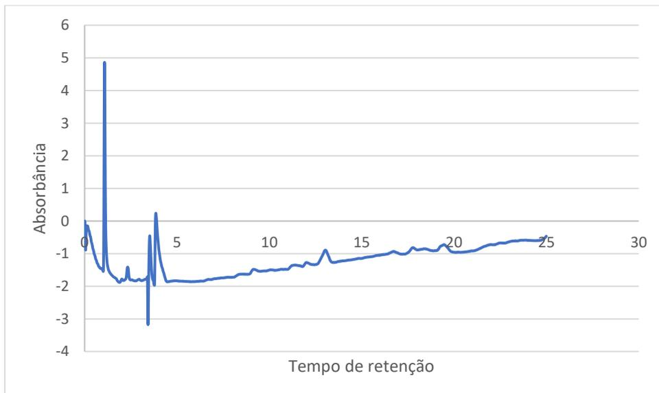
**Figura 6:** Perfil cromatográfico do extrato metanólico de *P. paradoxum* via cromatografia líquida de alta eficiência, modo de eluição gradiente exploratório, fase móvel H<sub>2</sub>O: MeOH (5 – 100 %). Comprimento de onda 254 nm.
