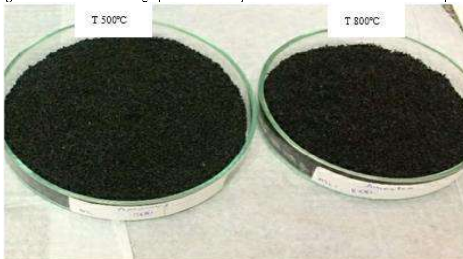
Figura 7 – Amostras de 50 g após a carbonização a 500 °C e 800 °C em forno mufla por 2h
