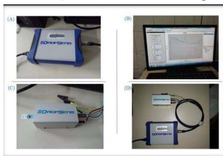
Nota: (A) Potenciostato, (B) Computador para análises, (C) Caixa acopladora do sensor eletroquímico e dos eletrodos do equipamento, (D) Equipamento completo.
