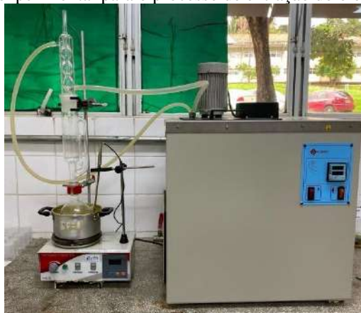
Figura 16 - Aparato experimental para o processo de extração do óleo da polpa do tucumã.
