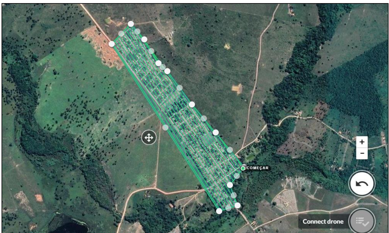
FIGURA 3: PLANO DE VOO NA PLATAFORMA DRONE DEPLOY/MURUMURU-MARABÁ-PA
