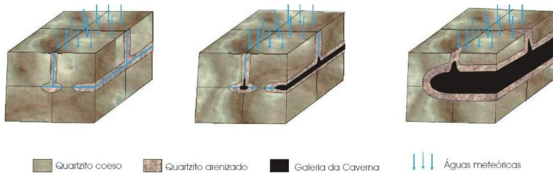
Figura 03 - Modelo de formação de condutos por arenização e piping.
