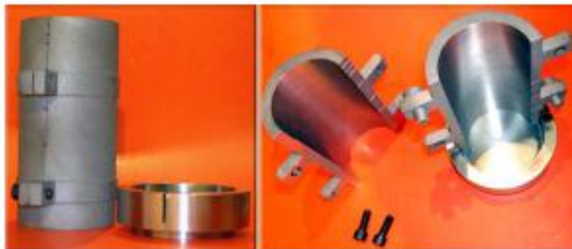
Figura 8 - Lingoteira em aço inoxidável e a chapa molde, em aço carbono e aço inox, utilizadas na solidificação ascendente e obtenção do lingote resultantes.
