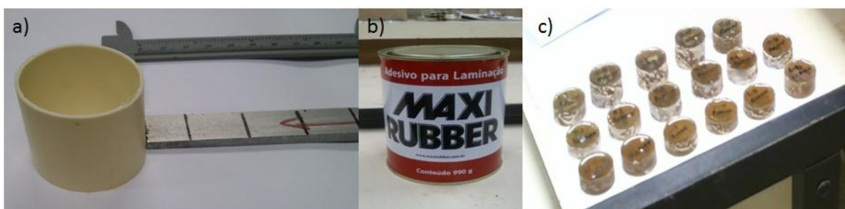
Figura 13 - Instrumentos de embutimento. (a) tubo de PVC; (b) Resina para embutimento; (c) Peças embutidas.
