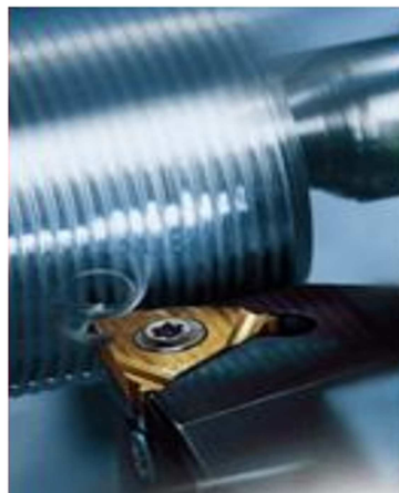
FIGURA 08 – Processo de corte de roscas.
