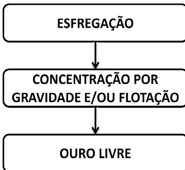
FIGURA 03– Fluxograma processamento de ouro aluvial
