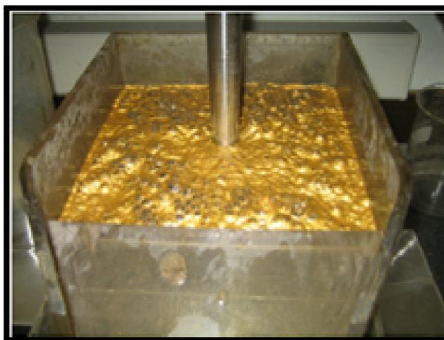
FIGURA 04 – Concentração de ouro de aluvião por flotação
